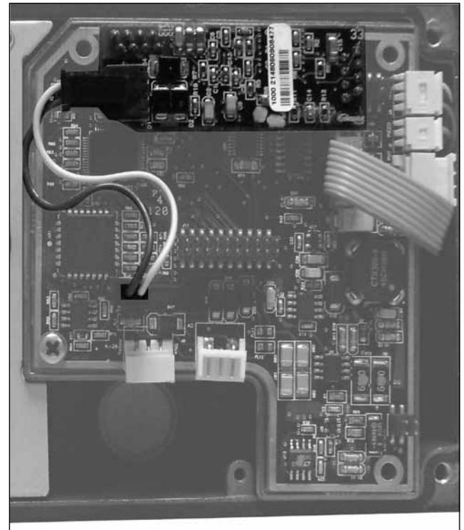
Abb. 6: 4-20 mA Analoge Rückmeldung - Platine
