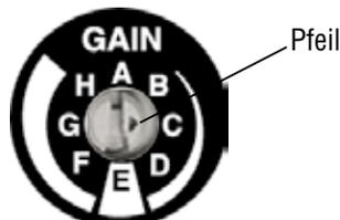
Ist der Drehauswahlschalter für die **Verstärkung** auf **E** gestellt, wenn der Auto-Tune Schalter auf **Ein** steht, erfolgt die Berechnung und Verwendung einer nominellen FLOWSERVE-Reaktionseinstellung.
